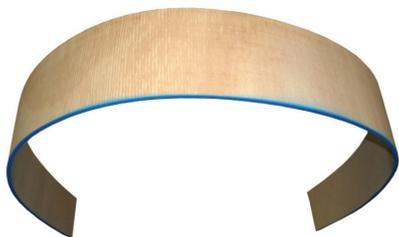
T-Flex è una spalla in micro lamellare da 8 mm appositamente studiato per la realizzazione del traverso superiore nei controelai centinati. Si possono produrre curvature anche molto accentuate sino a raggi inferiori a 15 cm T-Flex fa parte degli elementi che completano il sistema Termoframe rendendolo adatto a qualsiasi esigenza costruttiva.
